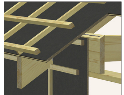
Övergång vägg/tak med utstickande takstolar/takbalkar
