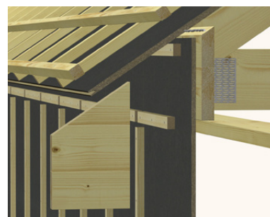
Overgang vegg/tak med løst utstikk
