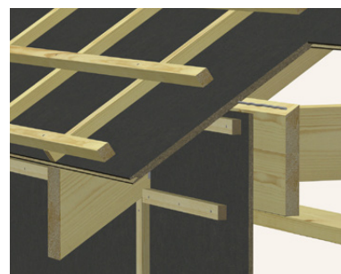
Overgang vegg/tak med sperreutstikk
