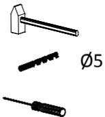
Mit Ø5 Bohrer durchbohren
