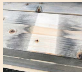
Impregneringsvätska når inte alla ytor
