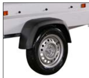
Hjul på siden og skærme i slagfast plast
