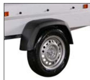
Hjul på siden og skærme i slagfast plast
