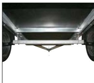
Kraftig aksel og solid understøttet finerbund
