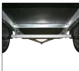
Kraftig aksel og solid understøttet finerbund
