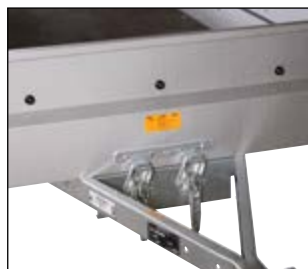
Solide lukkebeslag for sikker fastholdelse af lad
