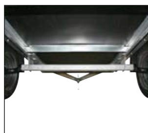
Kraftig aksel og solid understøttet finerbund
