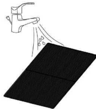
Bilde 2. Skyll luftfilteret under rennende vann.
