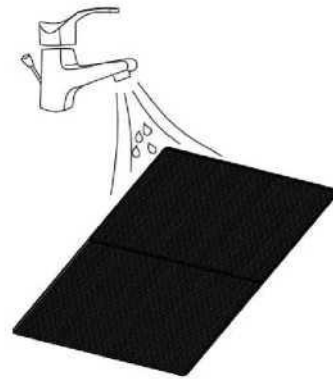
Obr 2. Opláchnite vzduchový filter pod tečúcou vodou.
