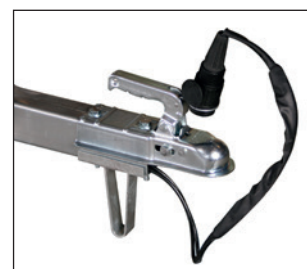
13 polet strømstik og kuglekobling med slidindikator
