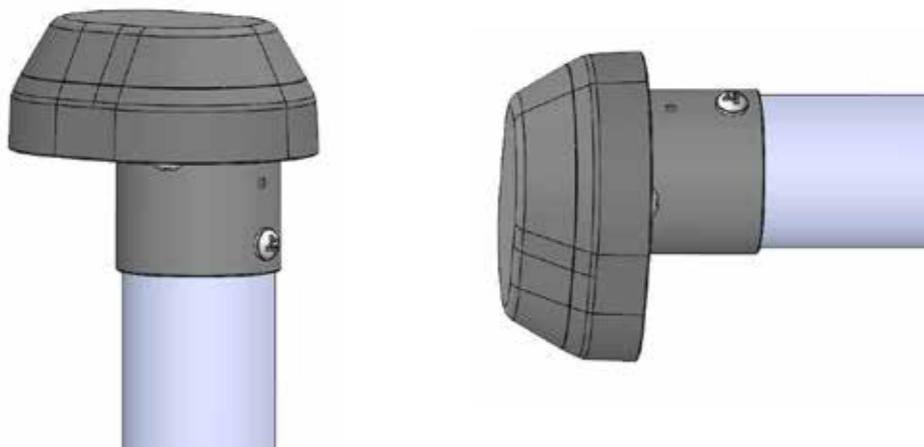
*Verifique que el inodoro esté conectado a la corriente, revisando si se percibe que hay una exhalación de aire a través de la salida de ventilación.*
