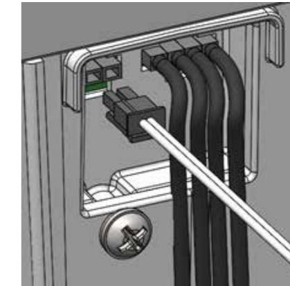
Les toilettes doivent être raccordées à une source d'alimentation. Les toilettes sont livrées avec une alimentation électrique 110-240 V et un câble 12 V. Quel que soit le choix de la source d'alimentation, le câblage est raccordé à l'arrière des toilettes à l'entrée indiquée sur l'illustration ci-dessus. Veillez à ce que les branchements soient correctement réalisés.
