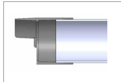
Tuuletusputken pää voidaan kiinnittää putkeen ruuvaamalla ohjeiden mukaan.
