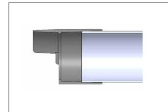
Ventilationsgaller går att fixera i röret genom att skruva fast röret i anvisningen på detaljen.
