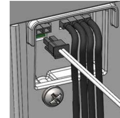
Toalettet må kobles til en strømkilde. Toalettet leveres med en batterieliminator for 110-240 V samt 12 V batterikabler. Uansett valg av strømkilde blir ledningene koblet til baksiden av toalettet via den merkede inngangen på bildet over. Sørg for at kontakten er festet ordentlig.
