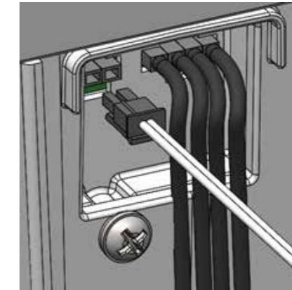
El inodoro debe estar conectado a una fuente de alimentación. El inodoro incluye un eliminador de baterías para 110-240 V y un cable de batería de 12 V. Independientemente de la elección de la fuente de alimentación, el cable se debe conectar en el lado posterior del inodoro, en la entrada señalada en la imagen anterior. Asegúrese de que el enchufe se conecte correctamente.
