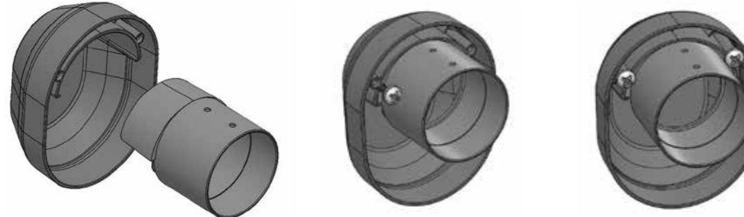
De sammansatta delarna monteras sedan som röravslut på samma vis som visat i tidigare avsnitt. Det är även möjligt att vid mer krävande förhållanden använda regnkåpan vid ett horisontellt röravslut för att tillse ett bättre skydd mot väder och vind.
