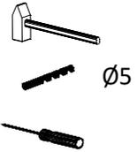
Mit Ø5 Bohrer durchbohren
