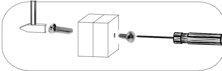
Mit Ø5 Bohrer durchbohren
