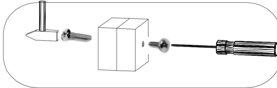
Mit Ø5 Bohrer durchbohren
