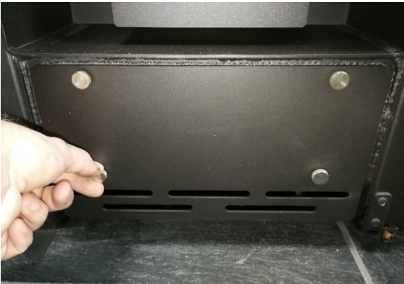
Foto 1: Retirar los tornillos y la plancha de acero para acceder al deflector.
