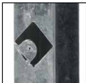
Laserskurna fästen och öppningar i 47x47mm
