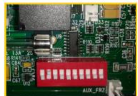
DIP-switch inställning modell Massimo II & Ferrara II: Kontakt nr. 2 ska stå i ON1( upp )
