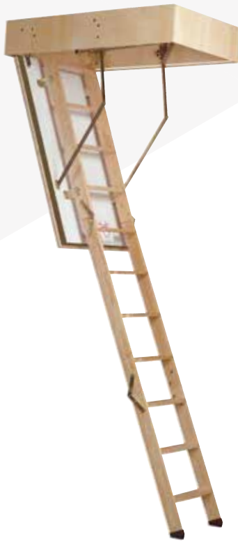
E130 EI30 brandklassad vindstrappa med 3-delad trästege och 50 mm isolering. U-värde 0,60 W/m 2 C.
