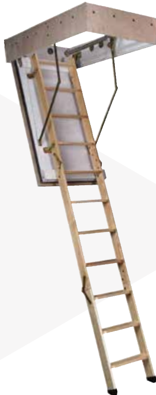
E190 EI90 brandklassad vindstrappa med 3-delad trästege och 50 mm isolering. U-värde 0,60 W/m 2 C.
