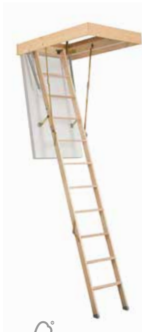
CLICKFIX 56 Vindstrappa med 3-delad trästege. 50 mm isolering. Beräknat: U-värde 0,62 W/m 2 C Testat: U-värde 0,64 W/m 2 C
