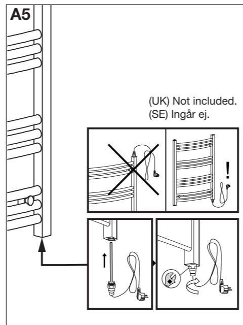
**(SE) Elpatronsdrift:** Skruva fast en propp (stopper) upp till och en propp ned till på ena sidan. Skruva fast elpatronen ned till. Fyll på med vätska genom det öppna hålet upp till. Skruva därefter fast luftventilen. Sätt på torken och töm systemet på luft genom att öppna luftventilen. Stäng luftventilen efter tömningen. Vätskeblandningen i systemet ska innehålla ca 20% glykol och 80% vatten.
