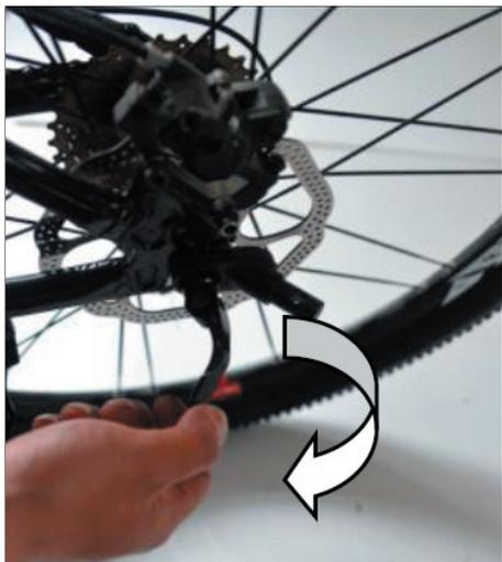
DK Monter sammenkoblingsanordningen på cyklens bagaksel.
