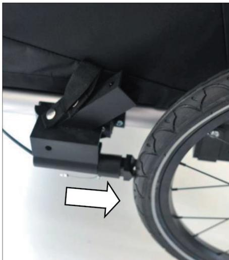
DK Bremseklossen presses mod dækket, til du slipper bremsehåndtaget igen.
