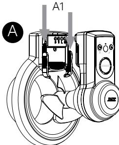
Lyft motorenheten ur ramstycket (se fig A) genom att först skjuta de båda låsknapparna mot centrum (A1). Tag därefter loss motorenheten (A2).
