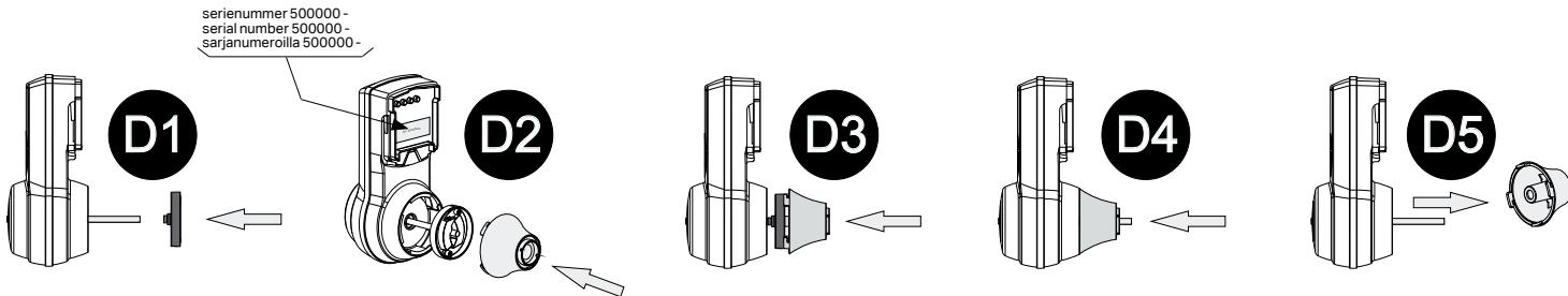
Montera regelhållaren genom att för hand pressa den rakt på axeln (D1).
