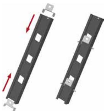
Monteringsbild 1. Börja med ändstolparna. Fästbeslag monteras i ändstolparna. Toppen av stolpen har ett litet hål i center, och klackarna på fästbeslaget skall peka uppåt. Drag beslagen uppåt innan skruvarna dras åt, så att det är möjligt att justera stolparna senare.
