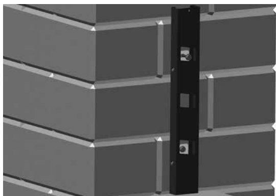
Monteringsbild 3. Rengör hålen innan betongskruvar 7,5 x 35 borrar in.
