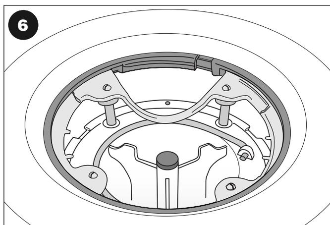
Så ser låsringen ut färdigmonterad i golvbrunn med förhöjningsring.
