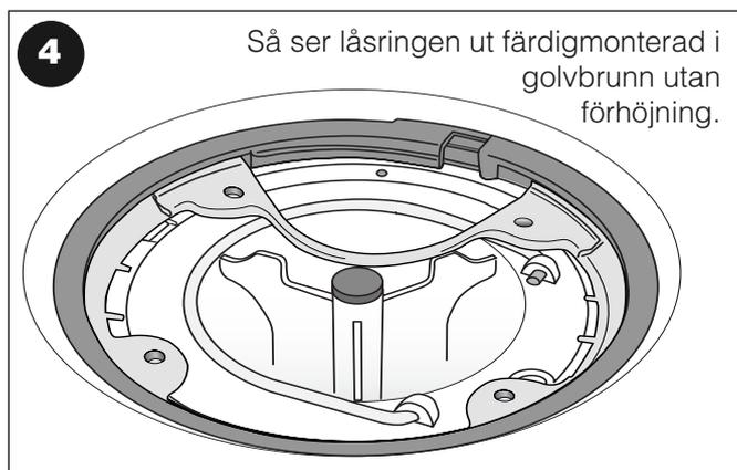
Hela låsringen ska nu sitta under klämringen. Vid montering i golvbrunn med förhöjningsring - se till att avståndspinnarnas underända (där den är kapad) går ned i de fyra stödhålen i vattenlåsets överkant.
