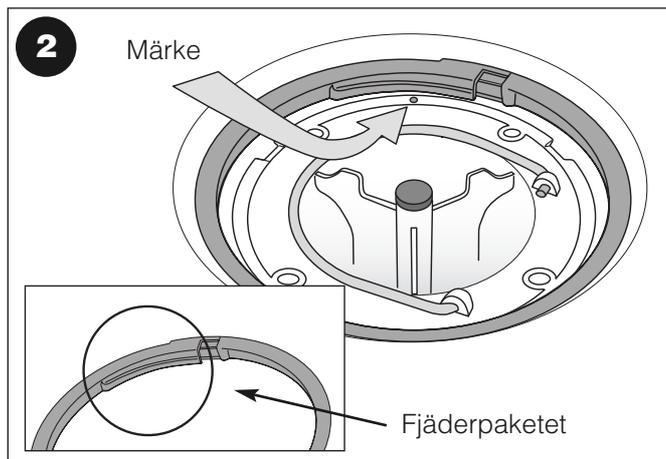
Noodvattenlåset ska placeras så att märket (rund fördjupning) är placerat rakt under fjäderpaketet på klämringen.
