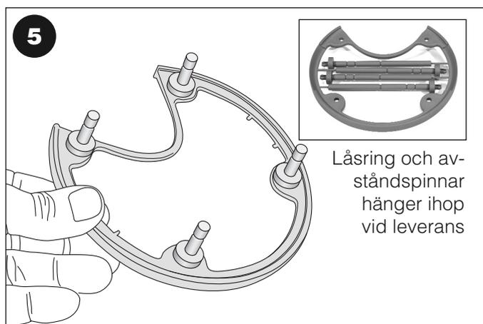
Avståndspinnarna klipps av så nära låsringens inneradie som möjligt. Vid montering i golvbrunn utan förhöjningsring används inte avståndspinnarna. Vid montering i golvbrunn med förhöjningsring ska avståndspinnarna användas enligt följande:
