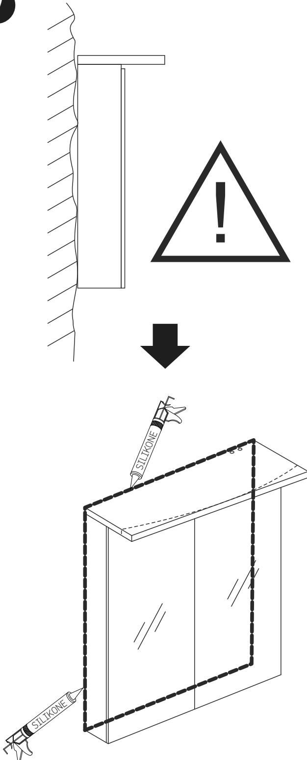
**S** Produkten är IP44 testad endast om den är installerad på en 100% rak och platt vägg. År din vägg inte rak kan tillverkaren inte garantera att ljusspegeln / spegelskåpet uppfyller IP44 norm. Därför rekommenderar vi att täta kanterna och utrymme mellan ljusspeglens / spegelskåpets ram och vägg med silikon. Det försäkrar en IP44 installation. Om en vattentät installation inte kan uppnås är spegeln av IP21 standard och kan installeras endast i zon 3. Se bilden i slutet av manualen.
