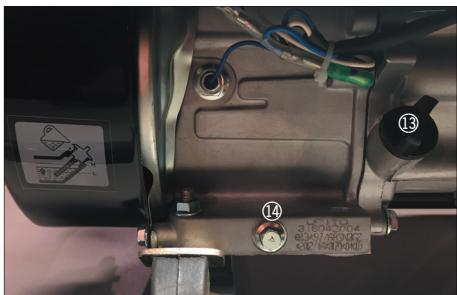
Öffnen Sie die Öldeckung und schrauben Sie den Ablasspfropfen ab. Kippen Sie den Generator und lassen Sie das gebrauchte Motoröl ab. Entsorgen Sie das gebrauchte Motoröl gemäß den jeweiligen örtlichen Vorschriften.
