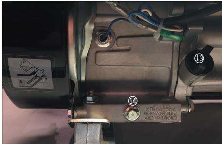
Retirez le bouchon du réservoir d'huile et dévissez le bouchon de vidange. Inclinez le générateur et vidangez l'huile moteur usagée. Éliminez l'huile usagée selon la réglementation locale en vigueur.
