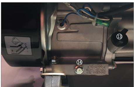
Odkręcić pokrywę wlewu oleju i odkręcić korek do spuszczania oleju. Przechylić generator i spuścić zużyty olej silnikowy. Zutylizować zużyty olej zgodnie z lokalnymi przepisami i regulacjami.
