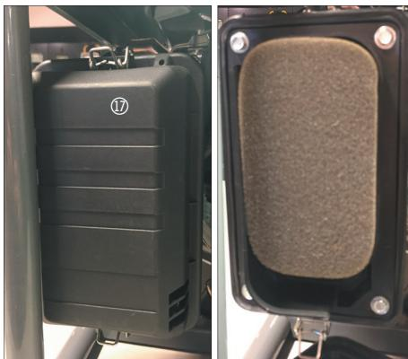
Ta ut filterelementet.
