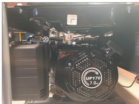
Ponga el estárter (20) en posición OFF para que la mezcla de petróleo sea más rica si el motor está frío. Si el motor está caliente, ponga el estárter en posición ON.
