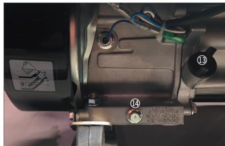
Öppna oljetanklocket och skruva av avtappningsproppen. Tippa generatorn och tappa ur den använda motoroljan. Den använda motoroljan ska kasseras enligt gällande regler i kommunen.
