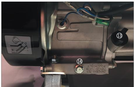
Aprire il coperchio dell'olio e svitare il tappo di scarico dell'olio. Tenere inclinato il generatore e attendere che fuoriesca l'olio esausto del motore. Smaltire l'olio esausto nel rispetto delle normative locali vigenti.
