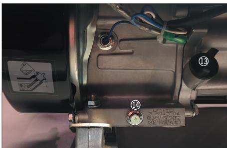
Avaa öljyaukon kanssi ja irrota tyhjennysaukon tulppa. Kallista generaattoria ja valuta käytetty moottoriöljy ulos. Hävitä käytetty moottoriöljy paikallisten jätehuoltomääristen mukaisesti.
