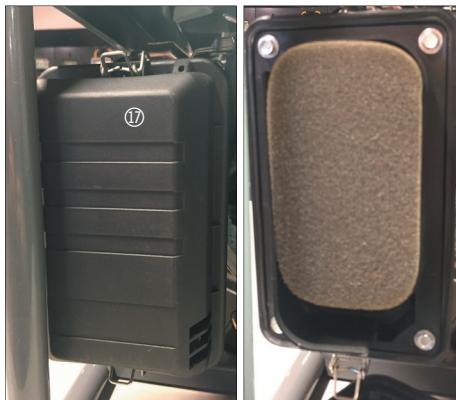
Ta bort filterelementet.
