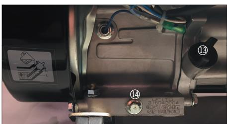
Abra la cubierta del aceite y desenrosque la cubierta de drenaje de aceite. Incline el generador y deje salir el aceite de motor usado. Elimine el aceite usado siguiendo las normas y reglamentos aplicables.
