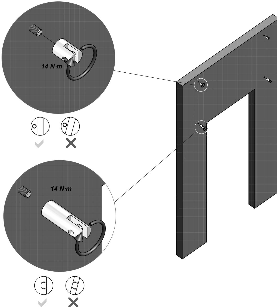
Montieren Sie die Wandgabelbefestigungen an den vormontierten Gewindestangen (M10). Achten Sie auf eine vertikale Ausrichtung der Gabelbefestigungen untereinander, hierbei sollte sich die Aussparung der Gabel parallel zur kurzen Glasseite befinden (siehe Bild).
