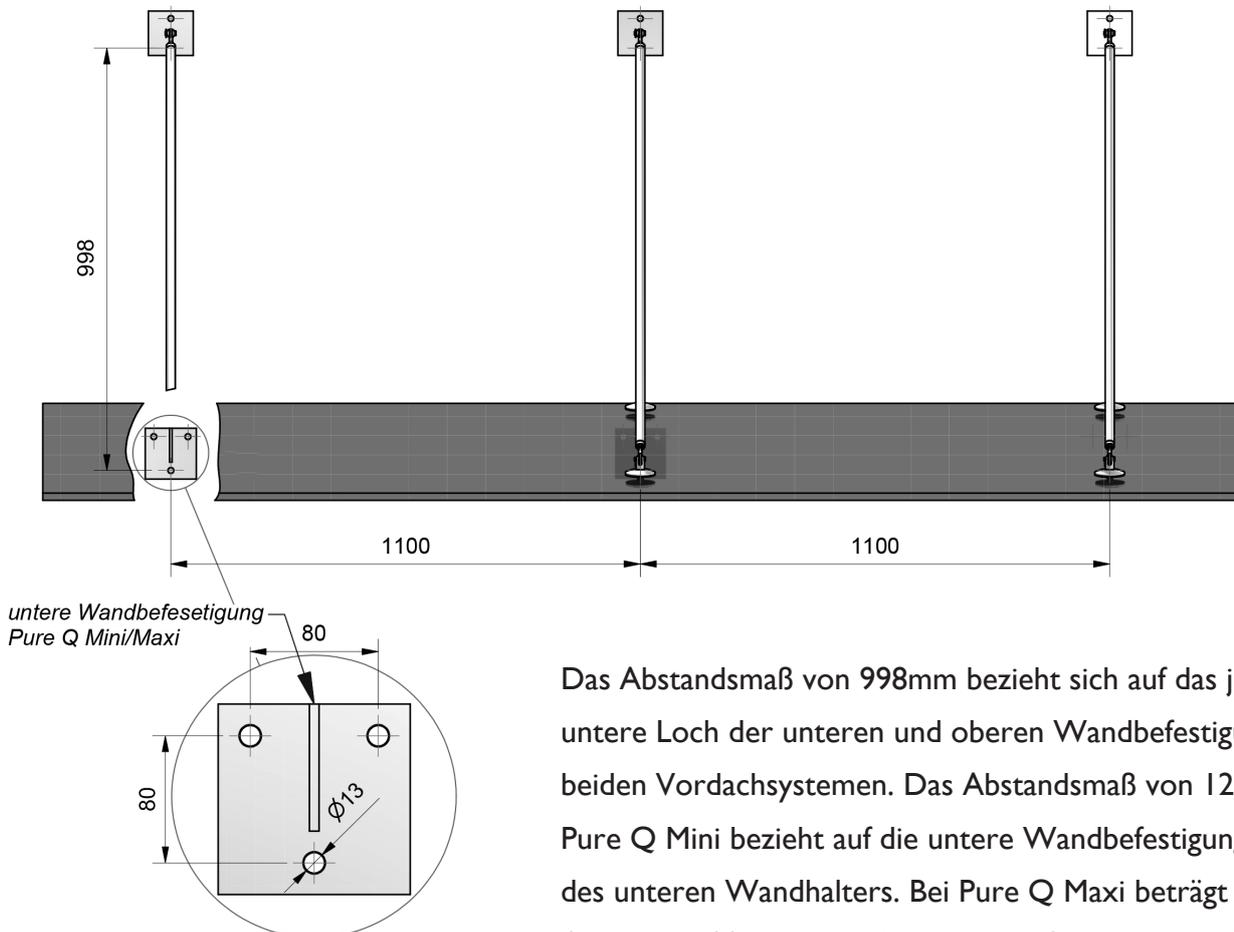
Das Abstandsmaß von 998mm bezieht sich auf das jeweils untere Loch der unteren und oberen Wandbefestigung bei beiden Vordachsystemen. Das Abstandsmaß von 1200mm bei Pure Q Mini bezieht sich auf die untere Wandbefestigungsbohrung des unteren Wandhalters. Bei Pure Q Maxi beträgt dieser Abstand 1100mm von Mitte Wandbefestigung zu Mitte Wandbefestigung.
