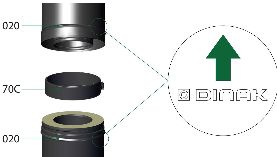
The picture shows the male and female assembly / Bilden visar montering av hane och hona / Bildet viser hann- og hunnmonteringen
